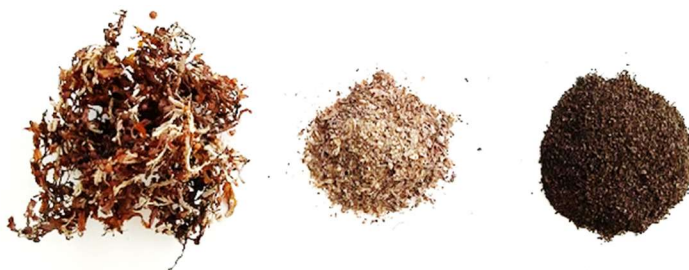
Figura 1. Sargazo natural, molido y pirolizado. Figure 1. Natural, ground and pyrolyzed sargassum.
