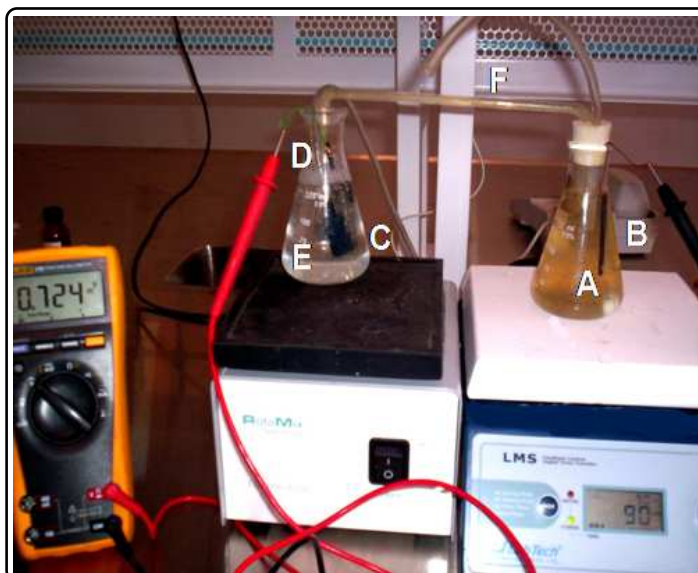
Figura 1. Reactor piloto tipo H utilizado en la primera etapa. A: Cámara del ánodo. B: Electrodo (grafito). C: Cámara del cátodo. D: Electrodo (grafito). E: Difusor. F: Puente salino.
