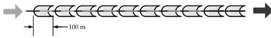
Figura 2. Esquema simplificado de la fila tipo de captadores solares cilindroparabólicos (CCP) considerada.
