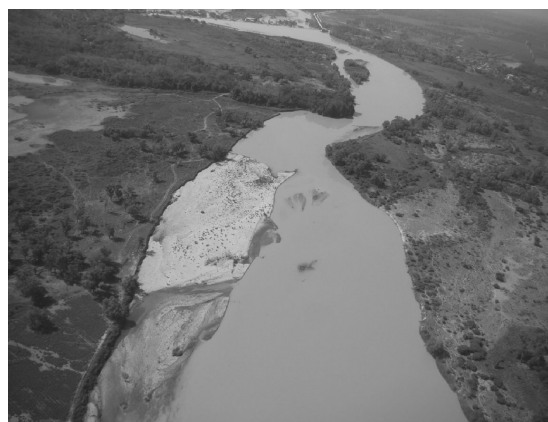
Figura 8. Efecto de sedimentación aguas arriba de la presa derivadora.
