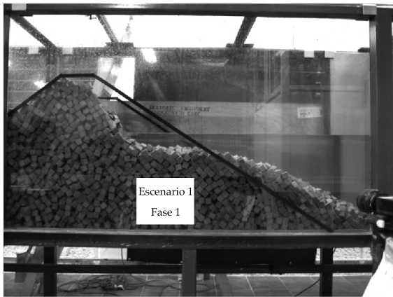
Figura 9. Imágenes de los perfiles estables para el escenario I en las fases uno y dos.
