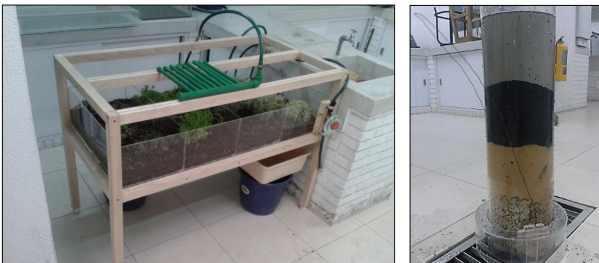
Figura 7. Prototipo de techo verde (izquierda) y filtro de arena (derecha).
