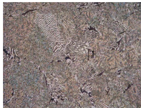
Figura 6: Muestra B 4, Zn - 22 % p Al - 2 % p Cu, 60 horas de homogenización a 375 °C, no muestra estructura tipo perlita bien definida.
