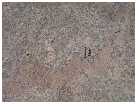
Figura 3: Micrografía de la muestra A 4, Zn - 22 % p Al, 60 horas de homogenización a 375 °C, no muestra estructura tipo perlita bien definida.
