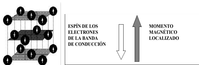
Fig. 5 Representación del efecto Kondo, interpretado como el acoplamiento antiferro magnético entre los espines de los electrones de la banda de conducción y el momento magnético localizado del metal.
