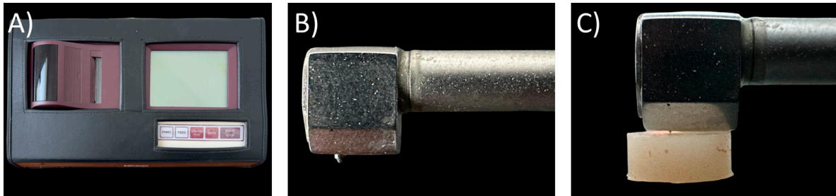
Figura 3. Prueba de rugosidad. A. Rugosímetro. B. Punta detectora con una punta de diamante. C. Muestra con punta detectora.
