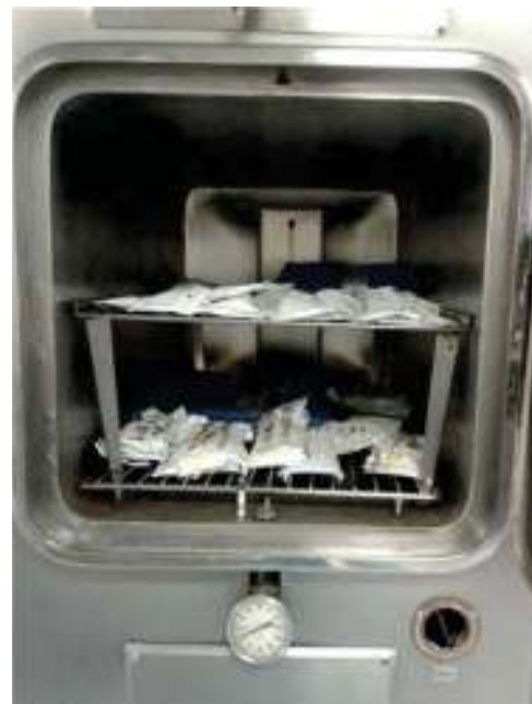
Figura 3. Autoclave con cargas no quirúrgicas.
