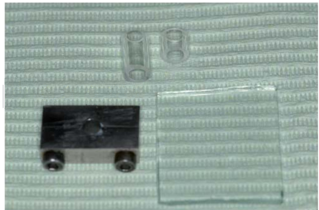
Figura 1. Base de cristal, molde hacedor de muestras y tubos de vidrio utilizados en este estudio.
