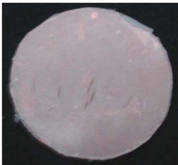
Figura 4. Disco de acrílico listo para la prueba de cromatografía de gases.
