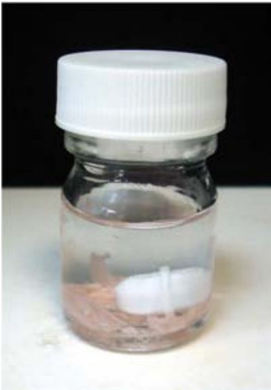
Figura 6. Frasco con la muestra pesada, se agrega THF como disolvente, y se coloca en una parrilla de agitación durante 72 ± 2 horas.
