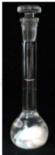
Figura 8. Solución precipitada con metanol después de 24 horas de reposo.
