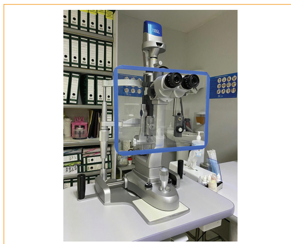
Figura 1. Separador plástico para lámpara de hendidura, fácil de hacer y adaptar para los diferentes tipos de lámparas.
