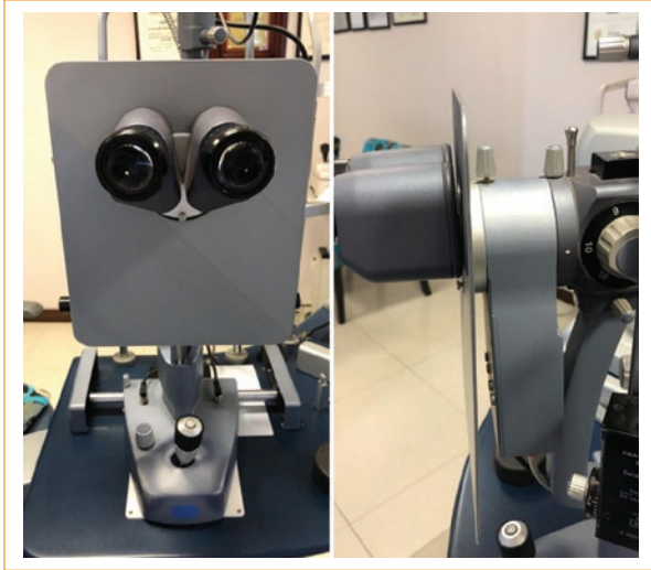
Figura 1. Colocación y uso de escudo protector en la lámpara de hendidura (cortesía del Dr. Manuel Garza León).
