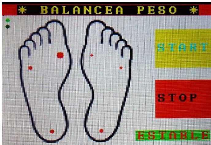
FIGURA 3. Pantalla touch del sistema donde se muestran los botones de inicio y paro de medición, magnitud de la fuerza aplicada a cada sensor y el estado de estabilidad o no.
