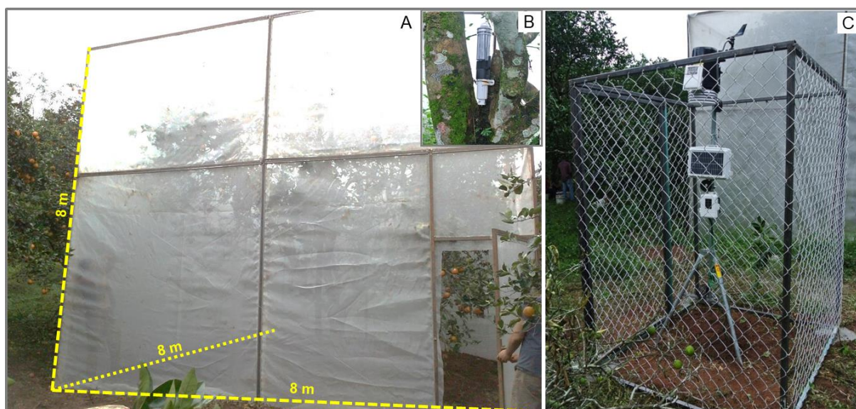
Figura 1. Estructura de Confinamiento por árbol, HLB-asintomático qPCR CLas positivo, de naranja Valencia Citrus sinensis / C. aurantium . A. Estructura metálica de confinamiento (8 x 8 x 8 m) con malla antiáfidos. Las estructuras incluyeron una puerta de acceso restringido mediante llaves; B. Sensor HOBO U23 Pro V2 de temperatura (°C) y humedad relativa (HR), programado para mediciones a intervalos de 30 min dentro del área confinada; C. Estación climática Davis Vantage para medición de variables climáticas complementarias como precipitación, velocidad y dirección de viento, evapotranspiración, etc.
