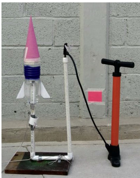
FIGURA 2. Cohete y plataforma de lanzamiento por sujeción de cables (Clark cable-tie launcher) empleada en el experimento.
