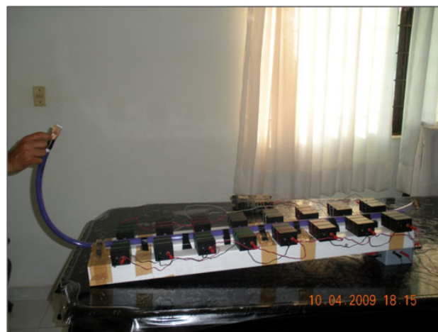
FIGURA 5. Montaje experimental para el experimento de movimiento rectilíneo uniforme.
