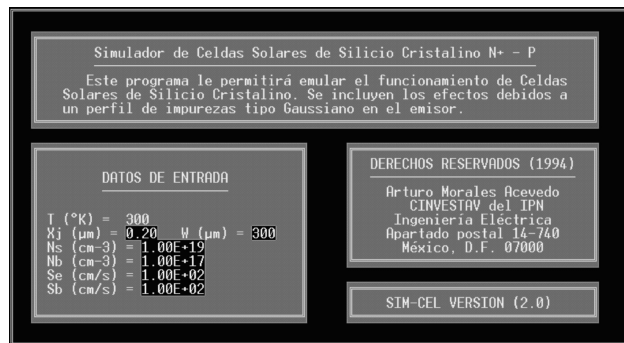
FIGURA 6. Pantalla de entrada de datos del programa de simulación de celdas solares de silicio que permite el diseño de la estructura y los procesos óptimos.
