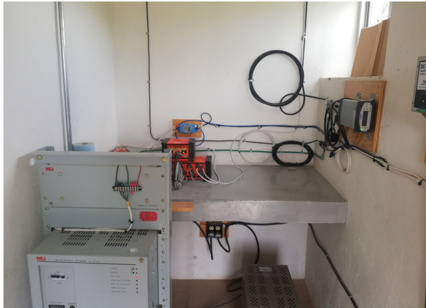
Figura 4. Estación sísmica de Tequisquiapan (TXMV), localizada en el Centro de Enseñanza, Investigación y Extensión en Producción Animal en Altiplano (CEIEPAA), de la Facultad de Medicina Veterinaria y Zootecnia de la UNAM, en Tequisquiapan, Querétaro. Se compone de un sensor STS-2, un digitalizador Q330 y un acelerógrafo Episensor. Los datos se comparten con el SSN y con el Consorcio IRIS.
