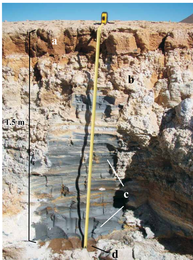
Figura 10. Perfil del dique de colas 2 (DC2) de mina Pan de Azúcar. a: Duripan; b: nivel oxidado; c: nivel inalterado con cristales de sulfuros; d: sustrato conglomerático.
