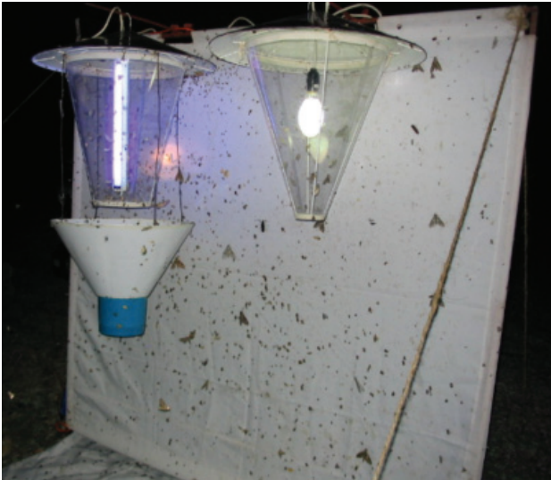
Figura 2. Trampa de atracción luminosa tipo Pennsylvania-Minnesota (modificada) utilizada en el muestreo de cantaroideos en 5 localidades con BTC de la sierra de San Javier, Sonora, México.
