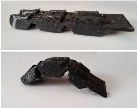
Figura 30. Pre doblado de falanges con calor. Fuente: elaboración propia.
