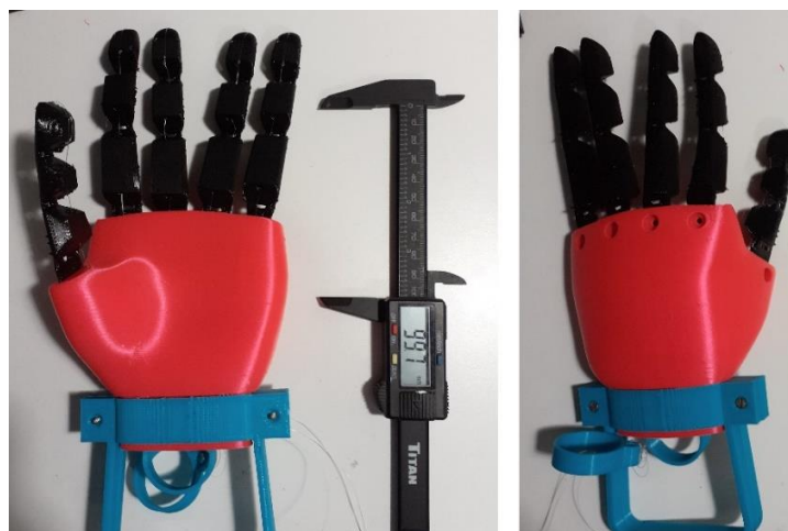
Figura 25. Prototipo con falanges impresas y unidas individualmente a la zona palmar de la mano. Fuente: elaboración propia.
