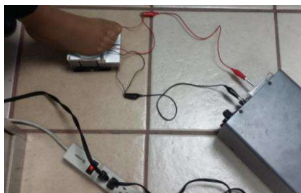
Figura 6. Prueba de enfriamiento sobre pie humano (González, 2017).
