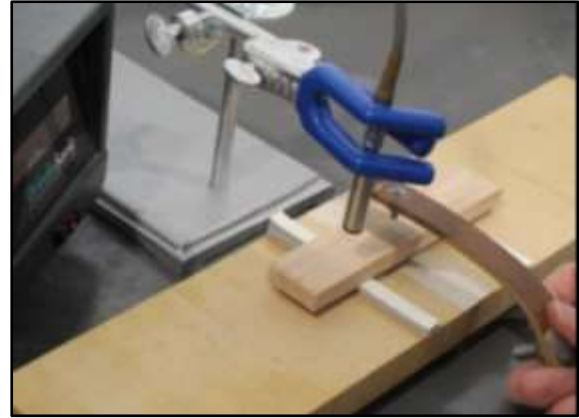
Figura 2. Pruebas de vibraciones transversales. Probeta de madera sólida.
