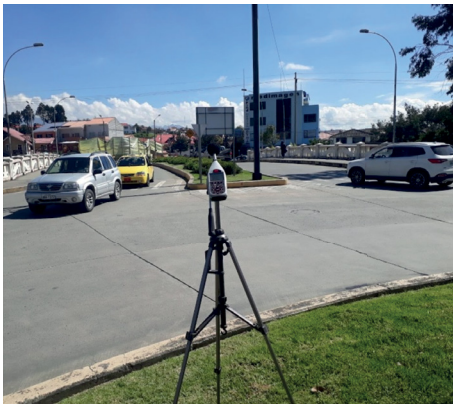
Fig. 4. Ubicación del sonómetro para las mediciones de validación de los nodos sensores (SCP11).
