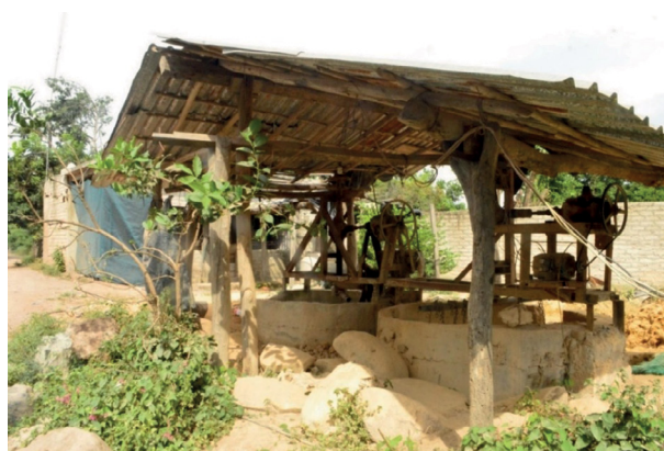
Fig 2. Molino de trituración para la extracción de oro, conocida como tauna. Comunidad de Las Habitas, El Rosario, Sinaloa.
