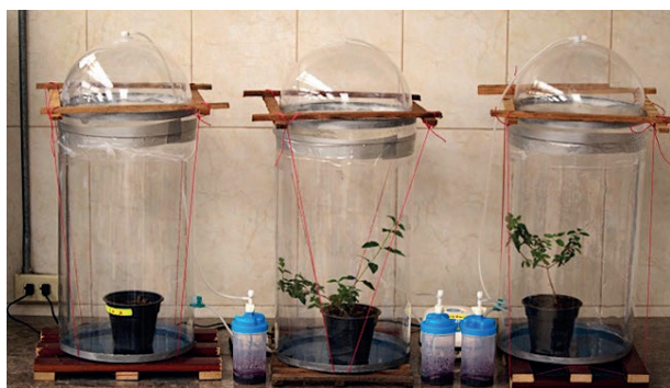
Fig. 2. Cámaras de volatilización con el sistema de flujo continuo de aire conducido a una solución trampa captadora del mercurio elemental. El estanco o sellado de las cámaras acrílicas se reforzó añadiendo petrolato a las juntas de las tapas y adicionando una base y un marco sujetador de madera unidos por cordeles.
