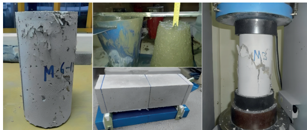
Fig. 4. Probeta cilíndrica con fibras de politereftalato de etileno después del ensayo a la compresión. Espécimen prismático y medición del asentamiento.
