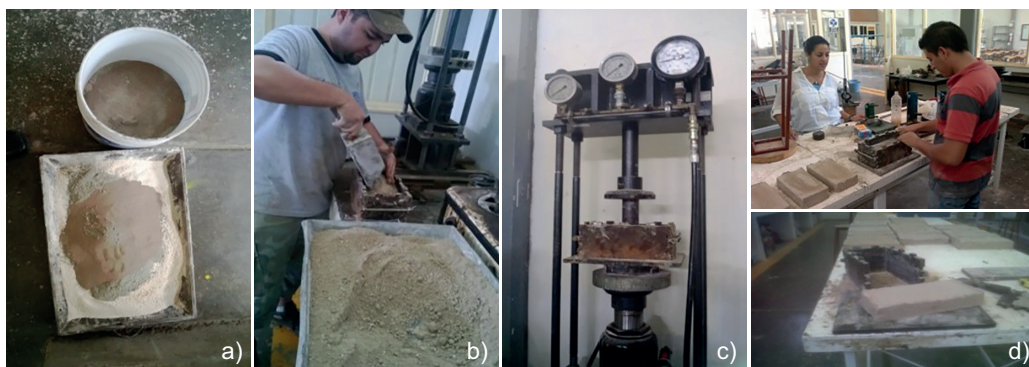
Fig. 3. Proceso de elaboración de ladrillos. a) Materiales en seco, b) llenado del molde, c) prensado de la mezcla y d) desmolde del ladrillo.
