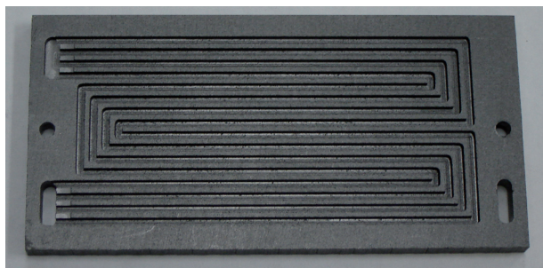
Fig. 6. Diseño de los campos de flujo de los platos bipolares del arreglo
