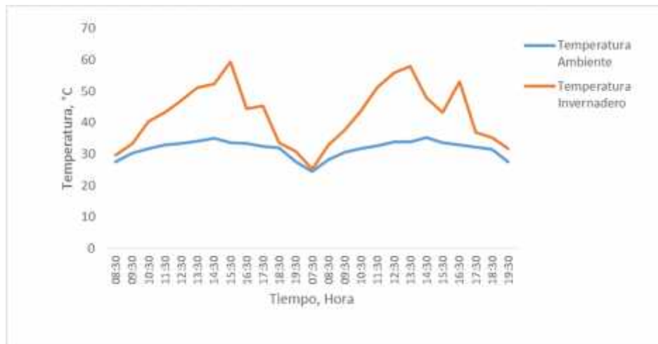
Figura 3. Comparación de temperatura ambiente con la temperatura interior del secador solar tipo túnel de polycarbonato en la Ranchería Miahuatlán, Cunduacán, Tabasco, México usando data Logger HOBO UX100-003.
