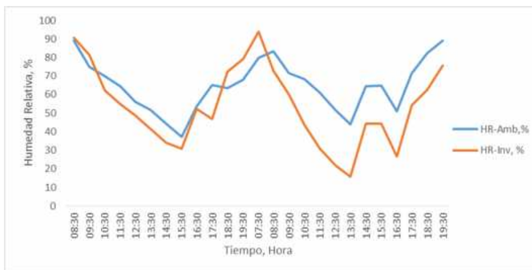
Figura 5. Comparación de la humedad relativa ambiente (%) con la del interior del secador solar tipo túnel de policarbonato en Miahuatlán, Cunduacán. Mediciones tomadas cada hora.
