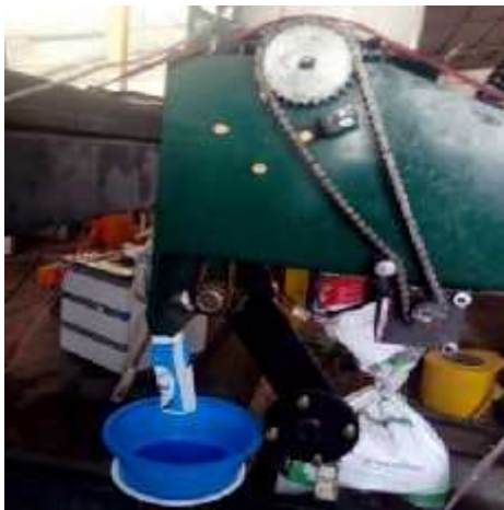
a) Fijación del motor al dosificador de fertilizante.
