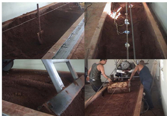
Figura 4. Proceso de preparación y acondicionamiento del canal de suelos para la realización de los experimentos en condiciones controladas.
