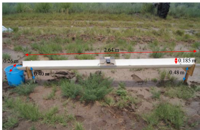
Figura 10. Canaleta pluviométrica instalada para medición de lámina aplicada.
