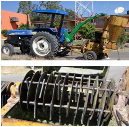
Figura 1. Molino de martillos: a) vista general del equipo; y b) tambor rotativo.
