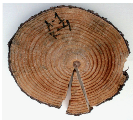
Figura 5. Toma de submuestra para la estimación de carbono en cada rodaja.
