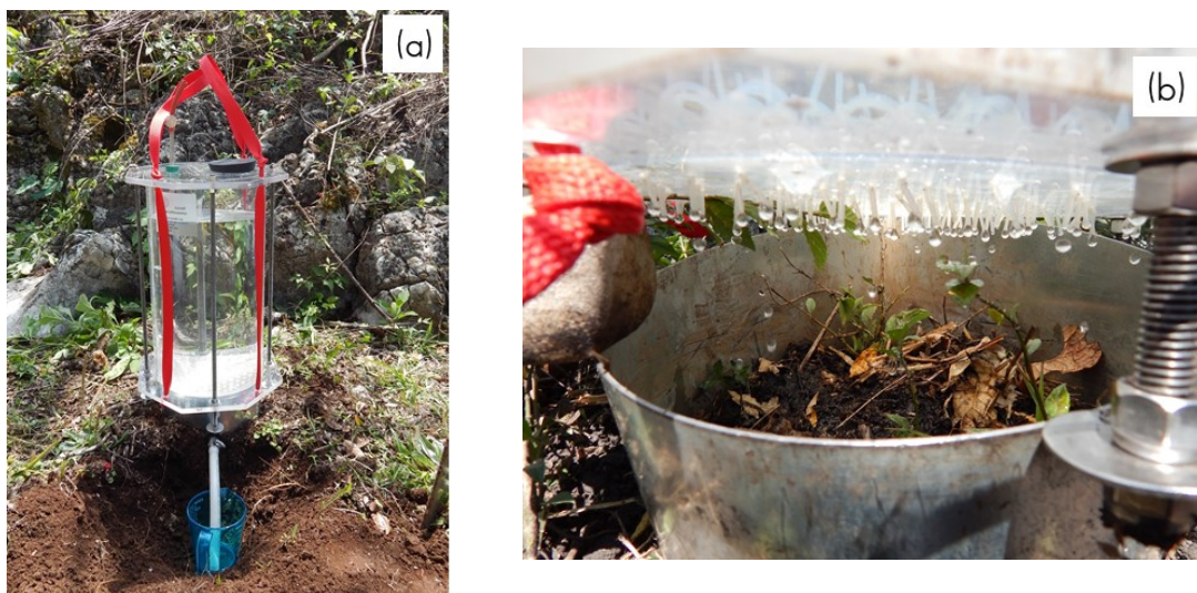
a) Infiltrómetro instalado en el sitio de estudio; b) Detalle del interior de una parcela de medición de escorrentía.
