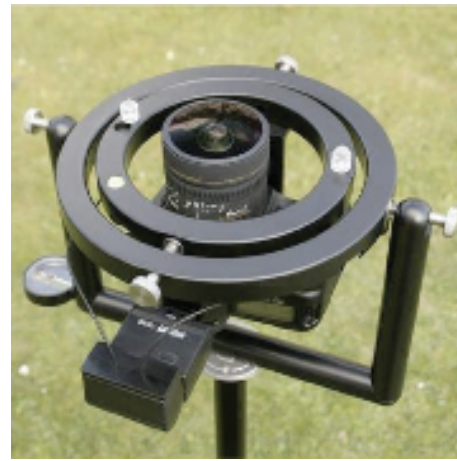
Figura 2. Cámara digital, lente hemisférica y soporte con estructura niveladora.
