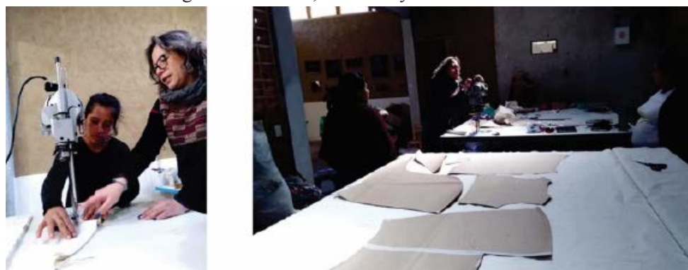
Figura 3. Tendido, marcado y corte industrial
