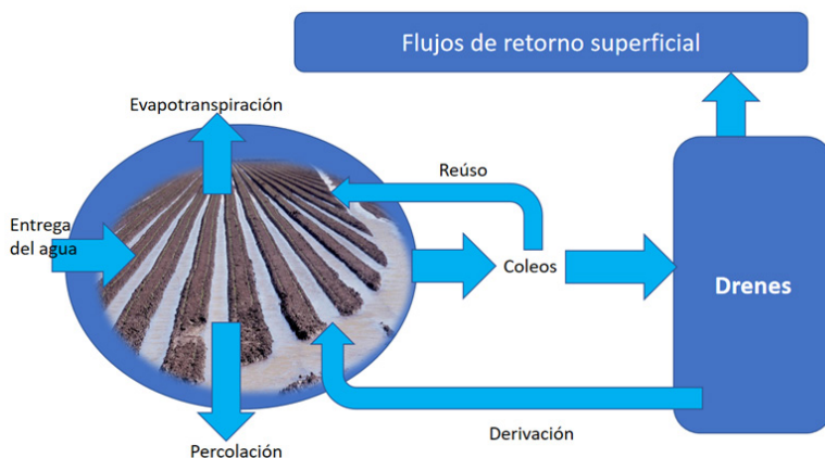
GRÁFICO 1. FLUJOS DE AGUA QUE SE PRESENTAN EN UN SISTEMA DE RIEGO PARCELARIO TRADICIONAL
