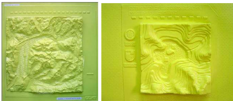
Figura 2. Mapas táctiles 3D en termoformado. Fuente: Informe final Proyecto IPGH, 2018.
