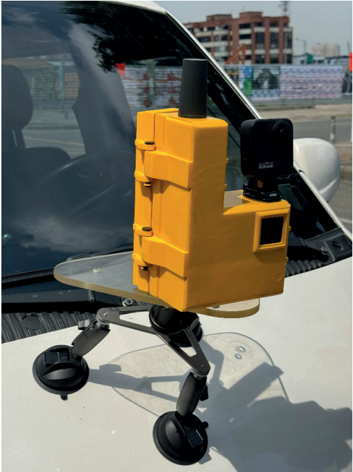
Figura 6. Sistema de mapeo móvil instalado en el vehículo.
