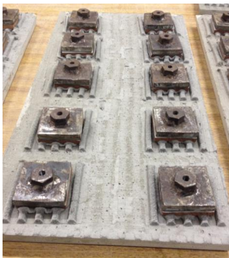
Figura 4. Peças metálicas coladas sobre as placas cerâmicas aderidas ao substrato-padrão.
