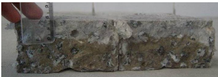
Figura 2. Possível precipitação de cloretos livres (branco) e cloretos combinados (marrom) (Medeiros et al, 2009).
