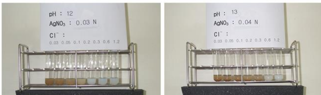
Figura 7. Análise da influência do pH na mudança de cor (KIM et al. , 2013).
