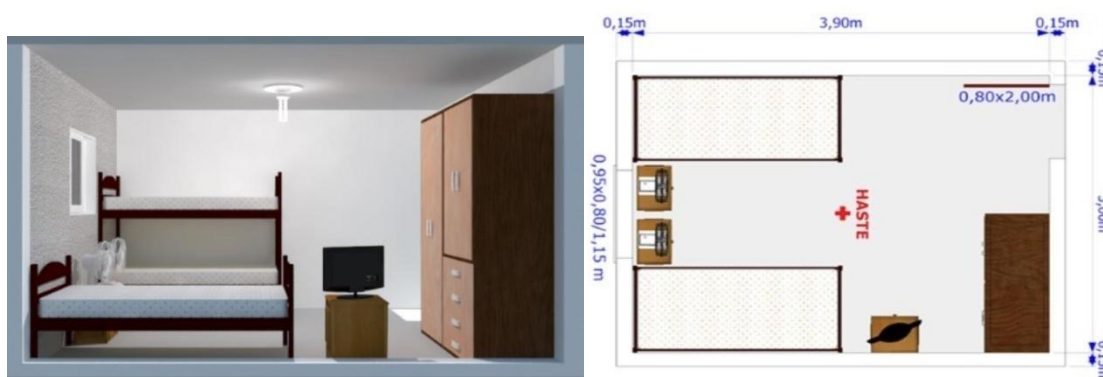
Figura 1. Ilustrações do ambiente ensaiado e distribuição dos termopares.
