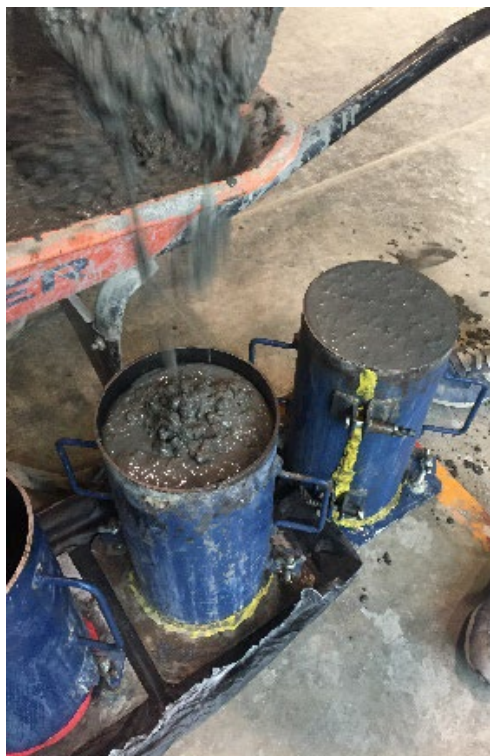
Figura 1. Llenado de cilindros con concreto autocompactable.
