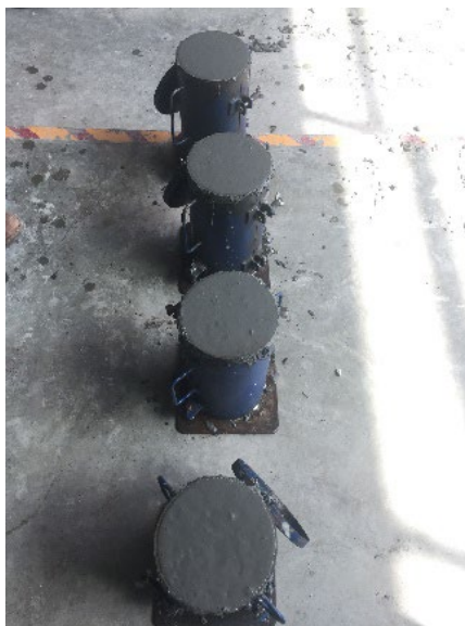
Figura 2. Preparación de cilindros para ensayos
