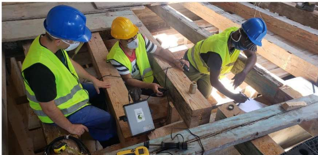
Figura 9. Aplicación de ensayos de VPU en vigas de madera
