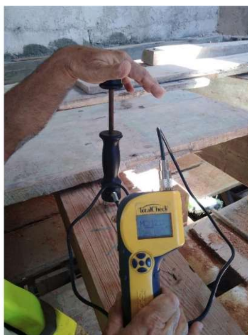
Figura 11. Medición de humedad superficial con equipo termo-higrómetro Delmhorst's TotalCheck
