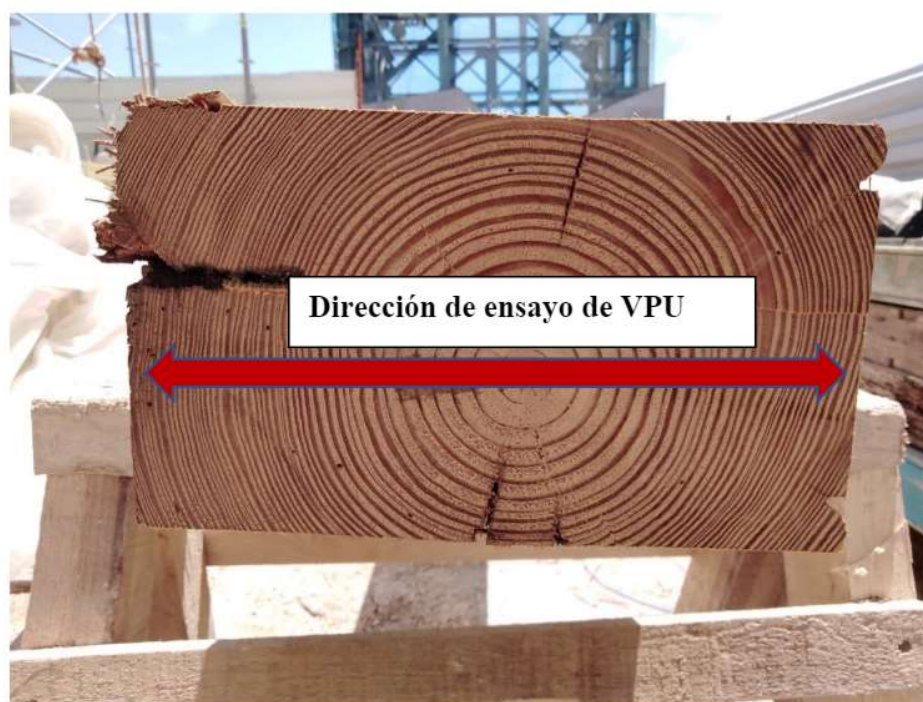
Figura 10. Esquema de aplicación de VPU perpendicular a la fibra
