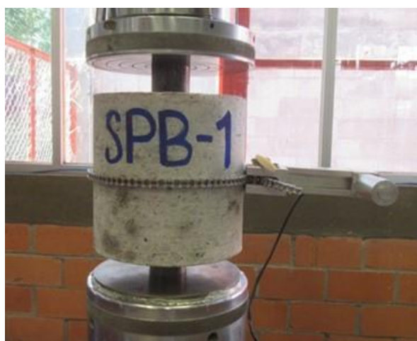
Figura 11. Ensaio de dupla punção, configuração, UNE 83515
