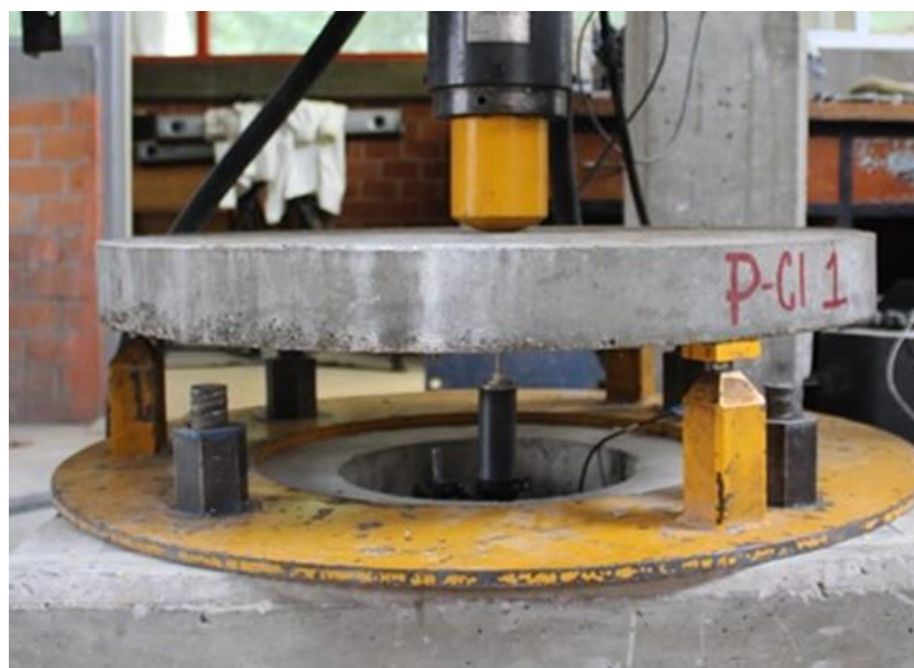
Figura 7. Ensaio de painel de seção circular, ASTM C1550
