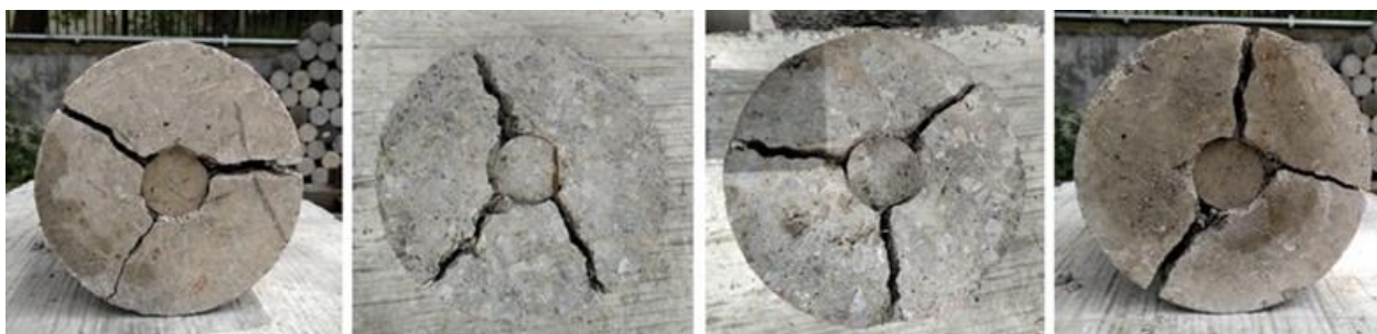
Figura 12. Modo de falha típico de cilindros, Ensaio de Barcelona.
