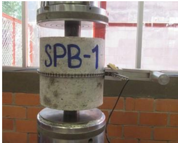
Figura 11. Ensayo de doble punzonamiento, configuración, UNE 83515
